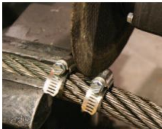
Après avoir fixé 3 colliers de serrage de chaque côté de la marque de coupe, la lame coupe la corde.
