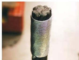
Si les pincettes de serrage ont été endommagées ou trop volumineuses pour l'installation, vous devez les remplacer toutes les 3 avec une saisie de fil.
