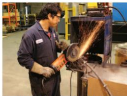
Ne pas utiliser une meule mais une lame de coupe en acier ; Par exemple : Elastique # 80EHT230-2.
