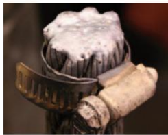
Filet de fil métallique bien fondu. Si elles ne sont pas endommagées au cours de la procédure de fusion, les pinces doivent être fixées à la corde.
